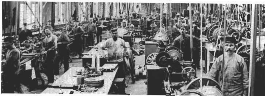
Máquinas movidas por polea en un taller del siglo diecinueve
